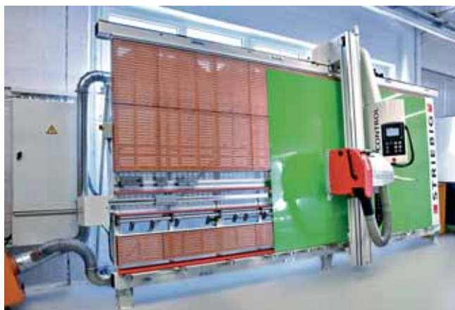
Zu den Vorteilen der vertikalen Sägetechnik von Striebig zählt auch die Möglichkeit, unterschiedliche Materialien platzsparend und effizient zuschneiden zu können
