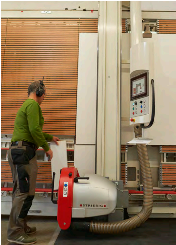
Der Plattenzuschnitt mit der 4D läuft programmgesteuert vollautomatisch ab. Lediglich das Werkstück muss noch manuell abgenommen und etikettiert werden.
