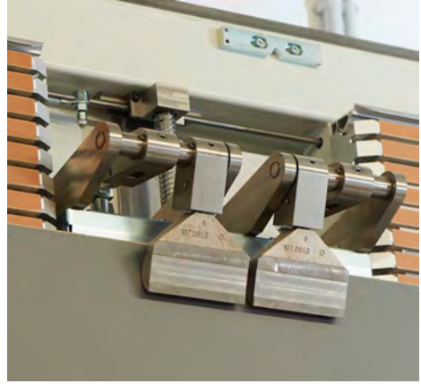
/ Die Spannanzgen der PAV-Plattenabsenkvorrichtung sorgen für sicheren Halt und vertikalen Transport.
