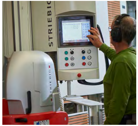
/ Platte auflegen, Programm auf dem Touchscreen auswählen und starten. Fertig.
