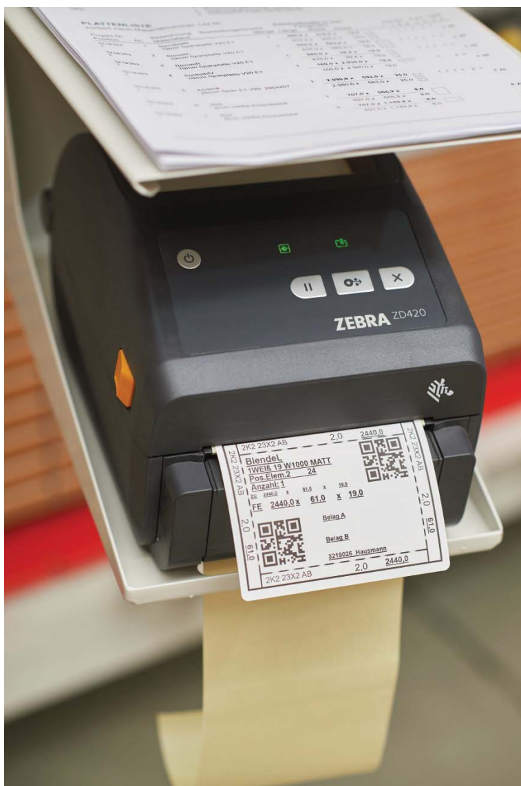
Fig. 5 : finies les recherches. Lors du processus de sciage découpe sur découpe, l'étiquette correspondante arrive directement de l'imprimante.
