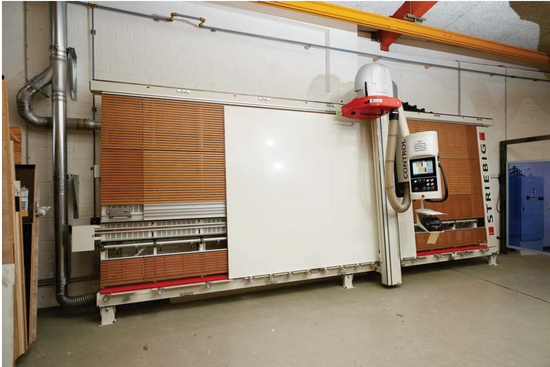
Fig. 6 : unique pour « presque » tout, la CONTROL avec l'option ExpertCut CON. Le panneau de commande 12", le système de positionnement électronique EPS.x, le positionnement automatique du chariot de scie ASP, l'imprimante d'étiquettes montée directement sous le panneau de commande, la connexion LAN et le logiciel d'optimisation de découpe assurent confort et économie lors de la découpe des panneaux.
