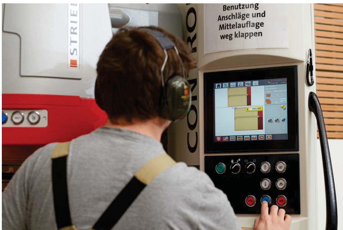
Fig. 1 : la CONTROL traite le plan de découpe presque automatiquement. Pascal Klehr n'enlève que les parties de panneaux découpés.
