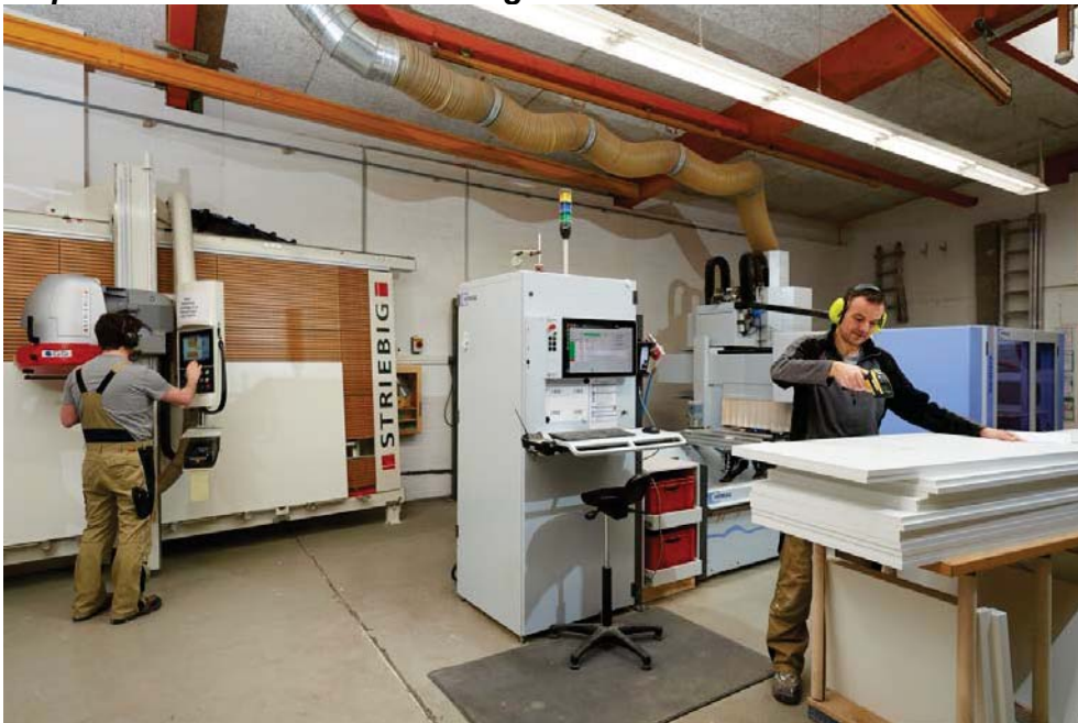
Fig. 4 : travail collectif et contrôle par logiciel. Pascal Kehr scie, Georg Bartz scanne les données pour le centre d'usinage CN : le 4.0 en menuiserie.
