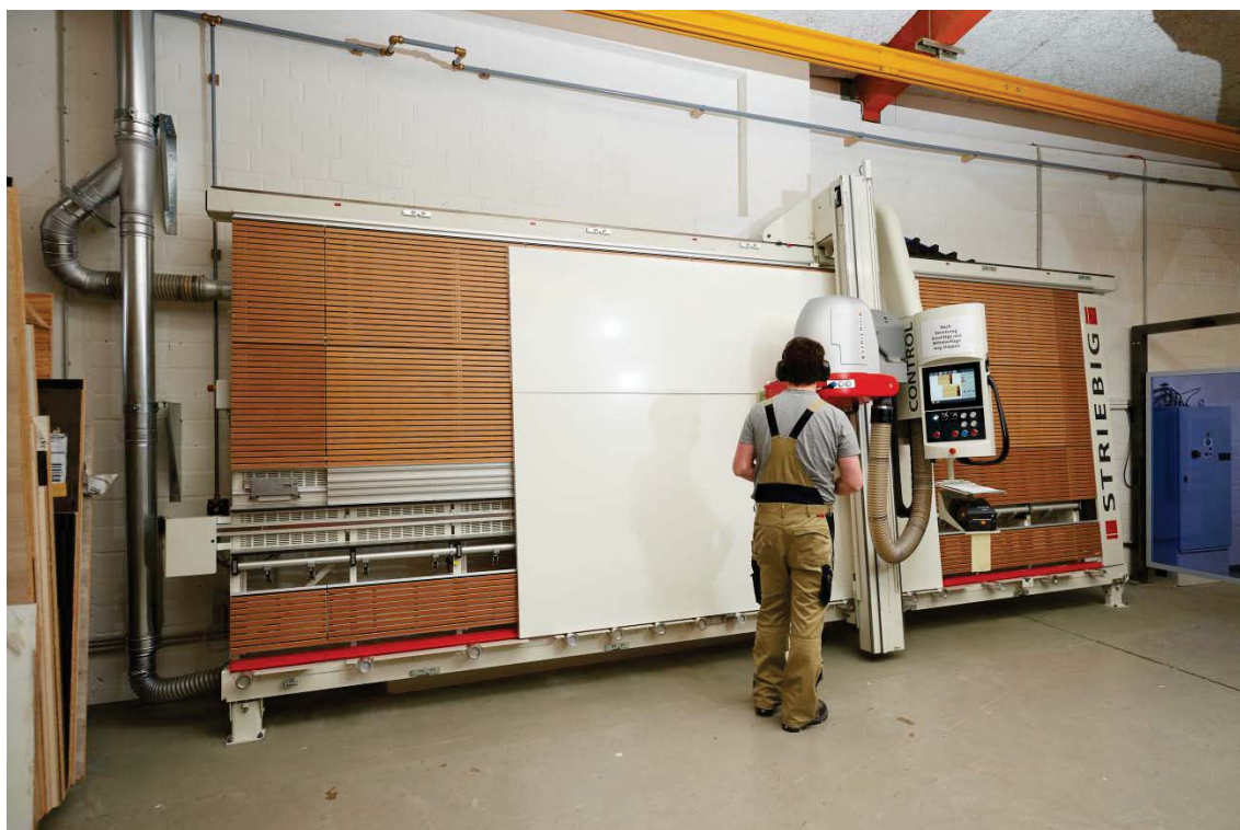
Fig. 1 : la CONTROL traite le plan de découpe presque automatiquement. Pascal Klehr n'enlève que les parties de panneaux découpés.
