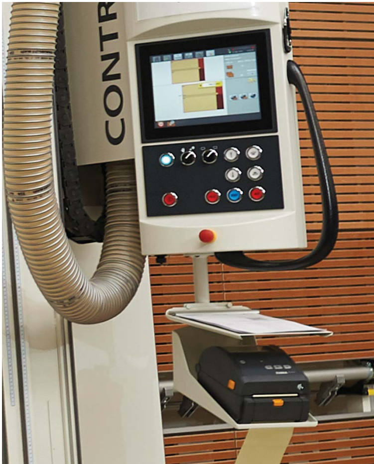
Abb.: 6 Eine für ‚fast‘ alles, die CONTROL mit der Option ExpertCut CON. 12“ Bedienterminal, elektronisches Positioniersystem EPS.x, automatische Sägebalkenpositionierung ASP, der direkt unter dem Bedienterminal montierte Etikettendrucker, LAN-Anschluß und Zuschnittoptimierungs-Software sorgen für Komfort und Wirtschaftlichkeit beim Plattenzuschnitt.
