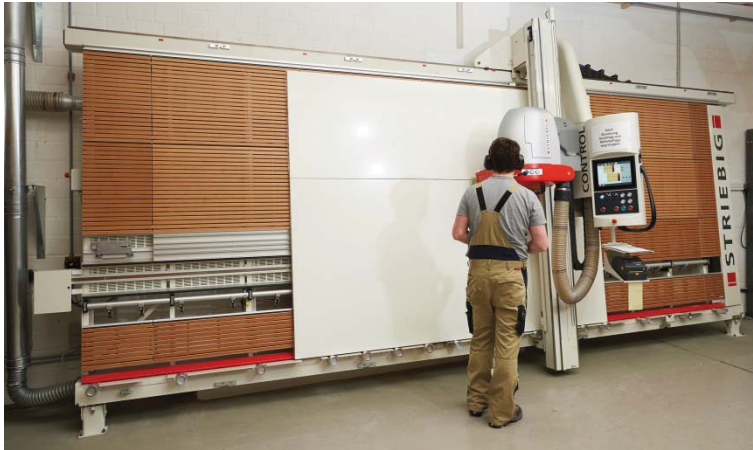
Abb. 1: Nahezu automatisch arbeitet die CONTROL den Schnittplan ab. Pascal Klehr nimmt nur noch die zugeschnittenen Plattenteile ab.
