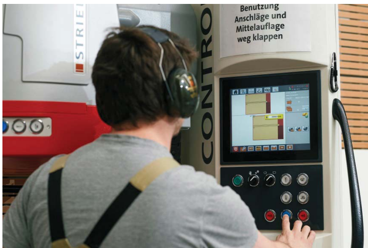
Abb. 1: Nahezu automatisch arbeitet die CONTROL den Schnittplan ab. Pascal Klehr nimmt nur noch die zugeschnittenen Plattenteile ab.
