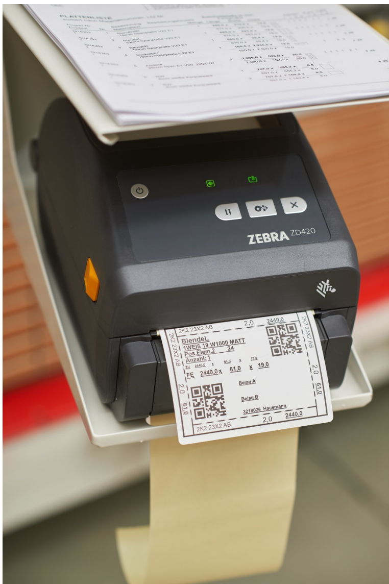
Figura 5: È finita l'era delle ricerche estenuanti. Si segano le sezioni a misura e l'etichetta corrispondente arriva direttamente dalla stampante.
