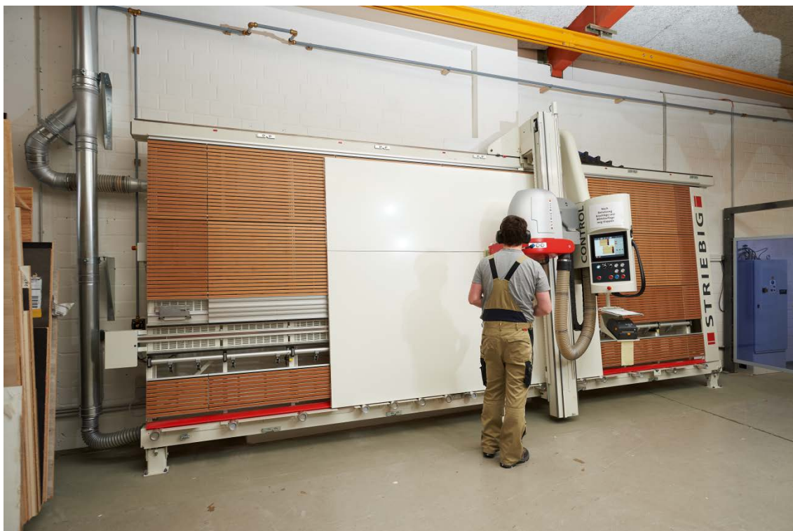
Figura 1: La macchina CONTROL elabora automaticamente il piano di taglio. Pascal Klehr deve solo prendere i pannelli tagliati a misura.
