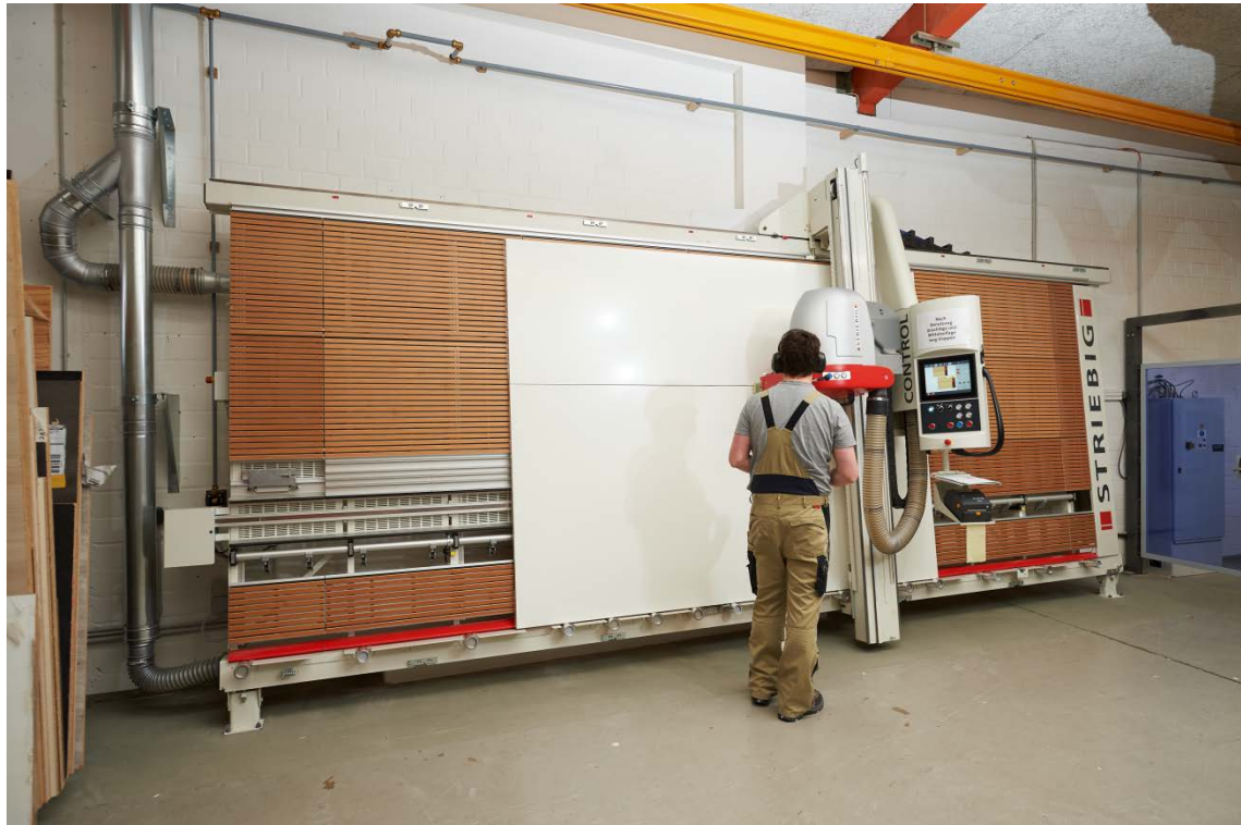
Fig. 1: El CONTROL procesa casi automáticamente el plano de corte. Pascal Klehr solo retira las partes cortadas del panel.
