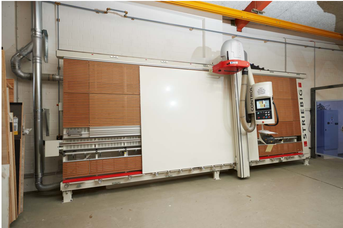
Fig. 6: Uno para (casi) todo, el CONTROL con la opción ExpertCut CON. El terminal del manejo de 12", el sistema de posicionamiento electrónico EPS.x, el posicionamiento automático de la barra de serrado ASP, la impresora de etiquetas montada debajo del terminal, el puerto LAN y el software de optimización de corte aseguran comodidad y rentabilidad en el corte de paneles.
