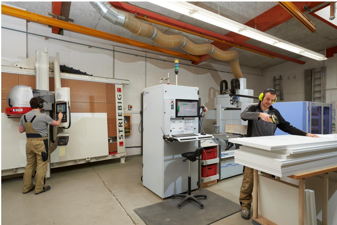
Fig. 4: Mano a mano y controlado por software. Pascal Kehr sierra, Georg Bartz escanea los datos para el CNC. 4.0 y carpintería artesanal.
