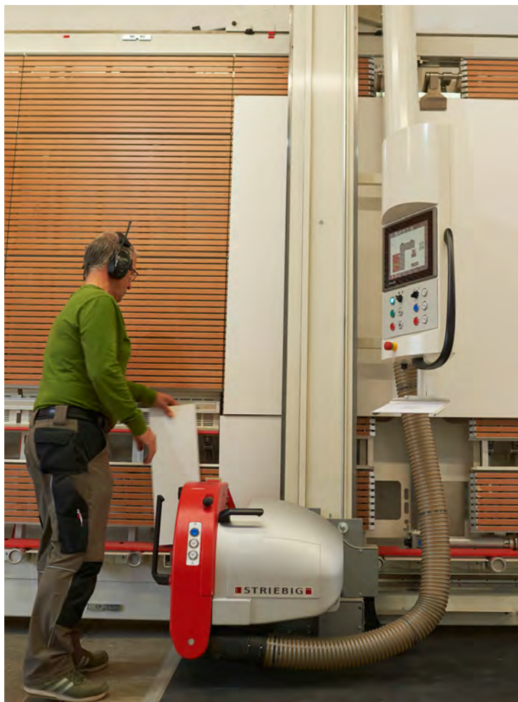
/ La sezionatura di pannelli con la 4D si svolge automaticamente in maniera programmata. Il pezzo deve solo essere rimosso ed etichettato manualmente.
