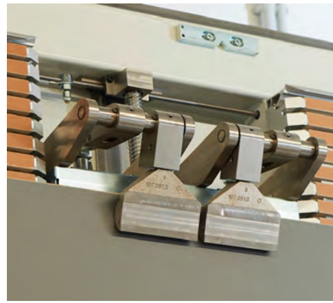
/ Les pinces de serrage du dispositif d'abaissement des panneaux PAV assurent un maintien sûr et un transport vertical.
