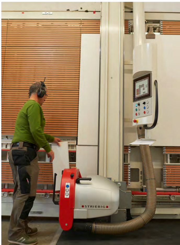
/ La découpe de panneaux avec la 4D est commandée par programme de manière entièrement automatique. Seule la pièce à usiner doit être retirée manuellement et étiquetée.
