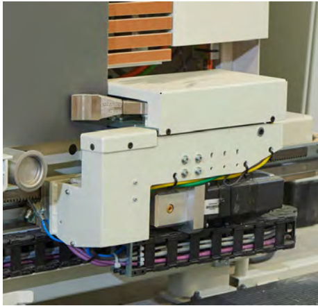
/ Transport automatique horizontal de pièces, via la pince de la vanne guillotine programmable.
