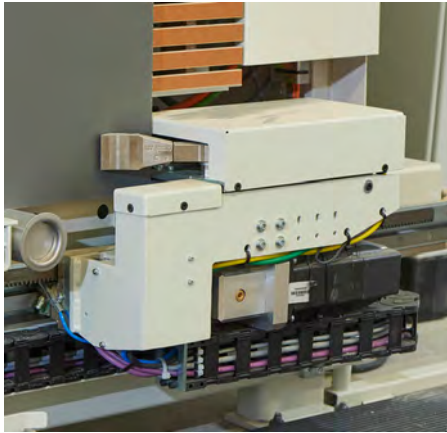
/ Transporte de piezas horizontal, automático, mediante las pinzas del desplazador de tabloncillos.
