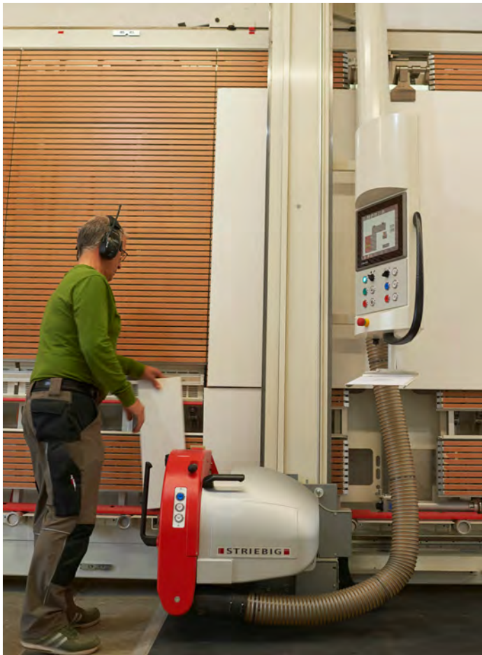
/ Con la 4D, el seccionamiento de tablonés se produce de manera totalmente automática a través de un programa. La única operación manual consiste en extraer y etiquetar la pieza.
