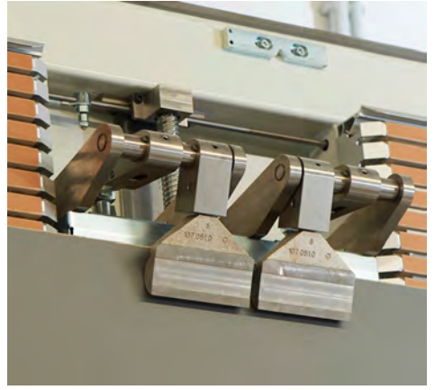
/ Las pinzas del sistema de inclinación de tabloncillos (PAV) proporcionan una sujeción segura y un transporte vertical.
